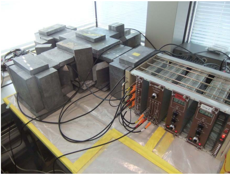
陽電子消滅分光法実験装置。
