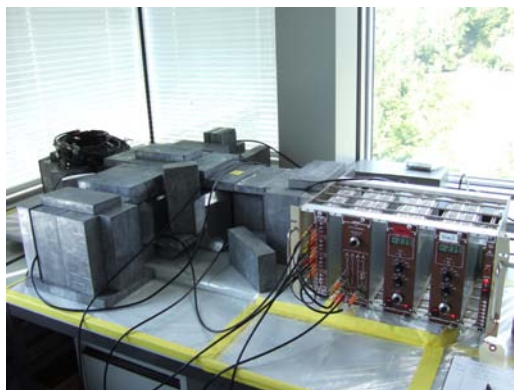
日本から輸送した装置。鉛ブロックの中に陽電子線源がある。
