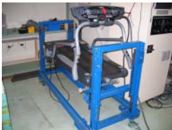
溶接による架台製作
